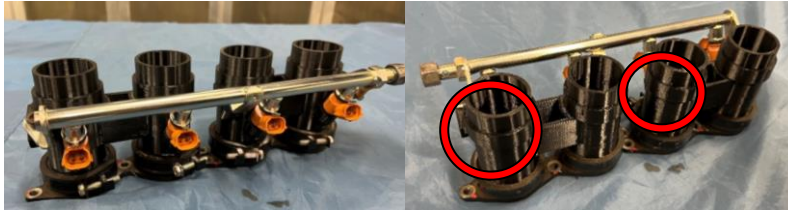
Fig.5 インロー試作品 (赤丸：2つのインローをつないでいる部分)
