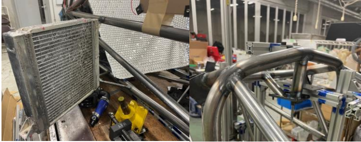
Fig.12 フレームに溶接した他パーツのステー
