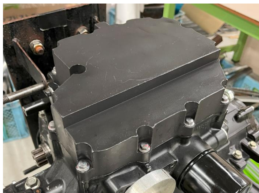
Fig.1 放熱加工を施工したオイルパン
