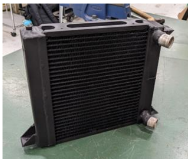
Fig.8 放熱加工を施工したラジエーター s
