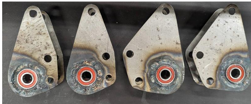
Fig19.シェイクダウン用ベルクランク
