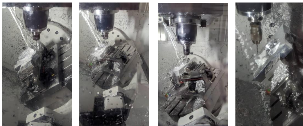
Fig24. アップライト加工の様子
