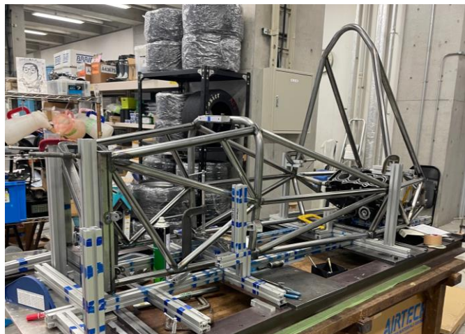
Fig14. 溶接したフレーム
