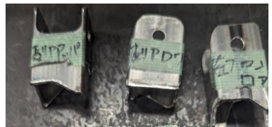
Fig20.左からタイロッドブラケット、プッシュロッドブラケット、A-arm ブラケット
