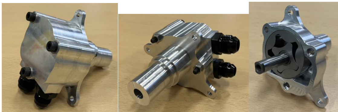
Fig1. スカベンジポンプ完成版外観（左、中）、内部（右）
