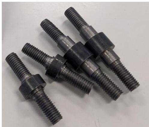
Fig10. 調整機構（ネジ部まで加工済み）
