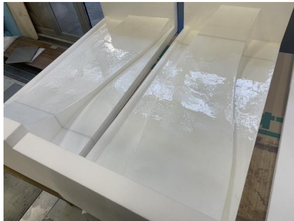
Fig28 樹脂をコーティングした後のアンダーパネル雄型
