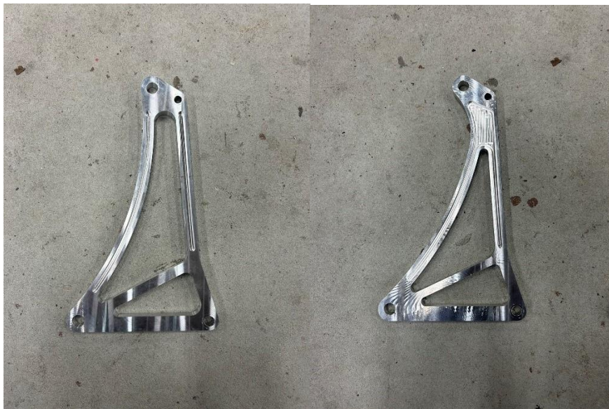
Fig8. 完成したデフマウント
