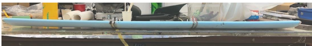
Fig20. 左側が浮いてしまったフロントウイング1枚目
