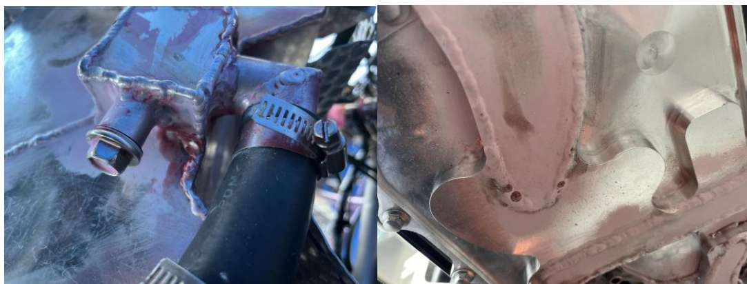
Fig.1 漏れミールによるオイル漏れチェック
