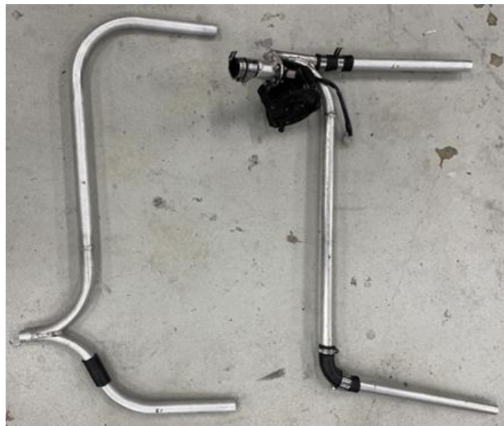
Fig6. 製作した冷却ライン
