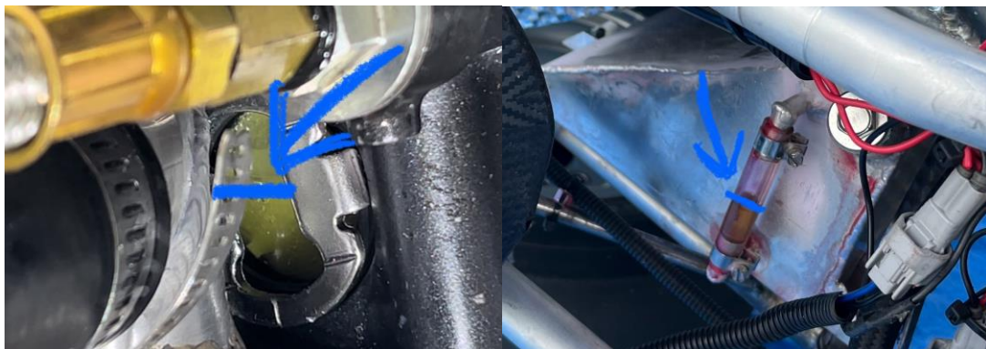
Fig4. 実際の油量（左：エンジン内部、右：オイルタンク内部）
