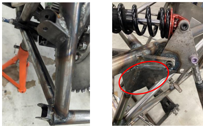
Fig13. (左図) A-arm ブラケット (右図) フロントベルクランクステー
