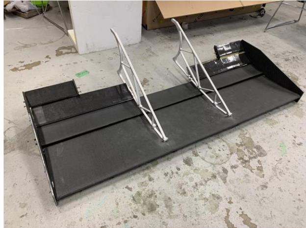
Fig.14 仮組みしたフロントウイング
