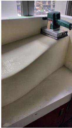
Fig.16 アンダーパネルの雄型のやすり作業
