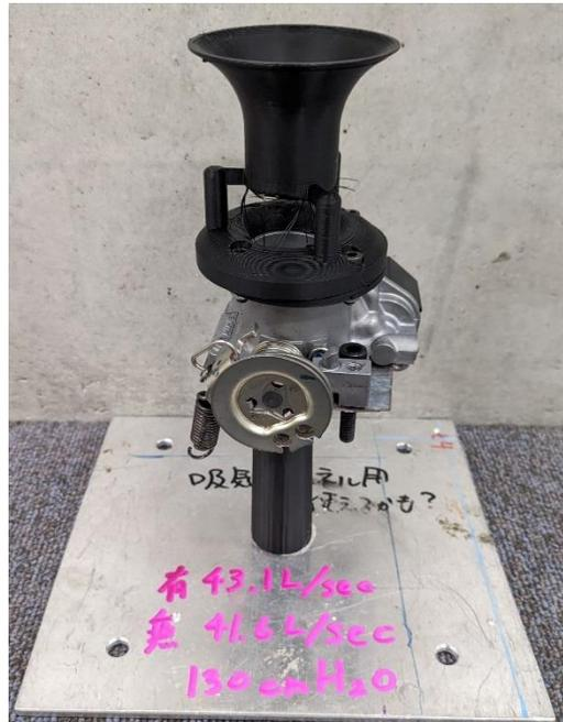
Fig5. ファンネル試験材
