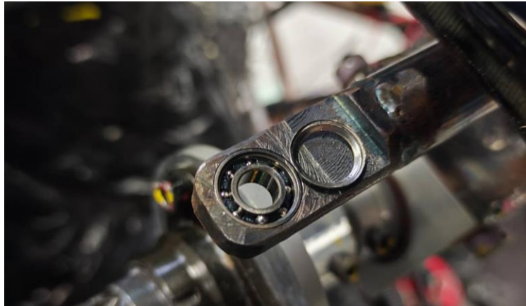
Fig.6 破損したベアリング
