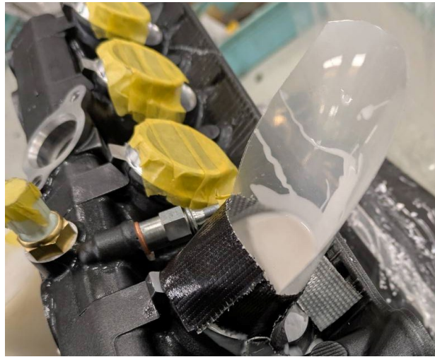
Fig.2 吸排気ポート形状計測
