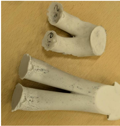
Fig.1 吸排気ポート形状計測に用いたシリコン
