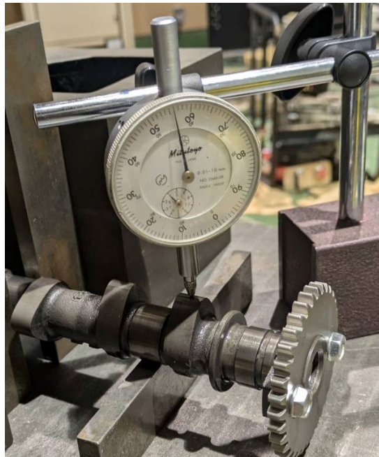
Fig.3 カムプロフィール計測
