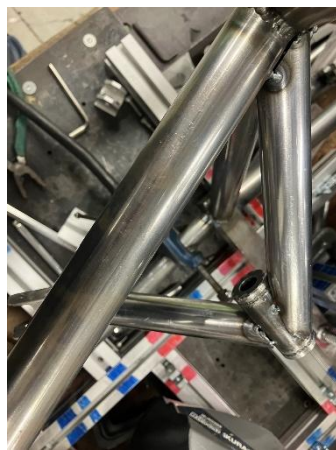
Fig.5 現在のフレームの様子（左）と溶接したエンジンマウント（右）
