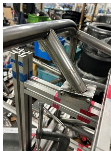
Fig.6 製作したクレビス（左）と溶接したステアリングマウント（右）
