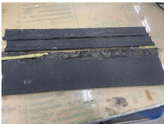
Fig.10 フラップ積層の様子
