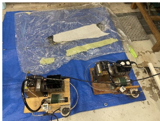
Fig.10 フラップ積層の様子
