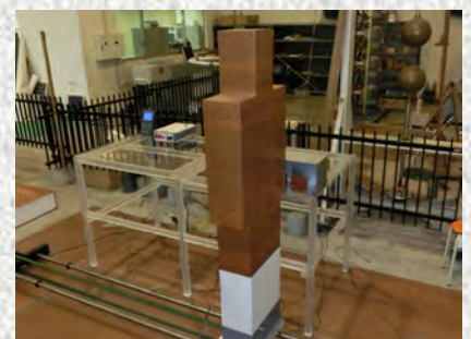
図3 帯電物体の移動による電子機器の誤動作の研究
