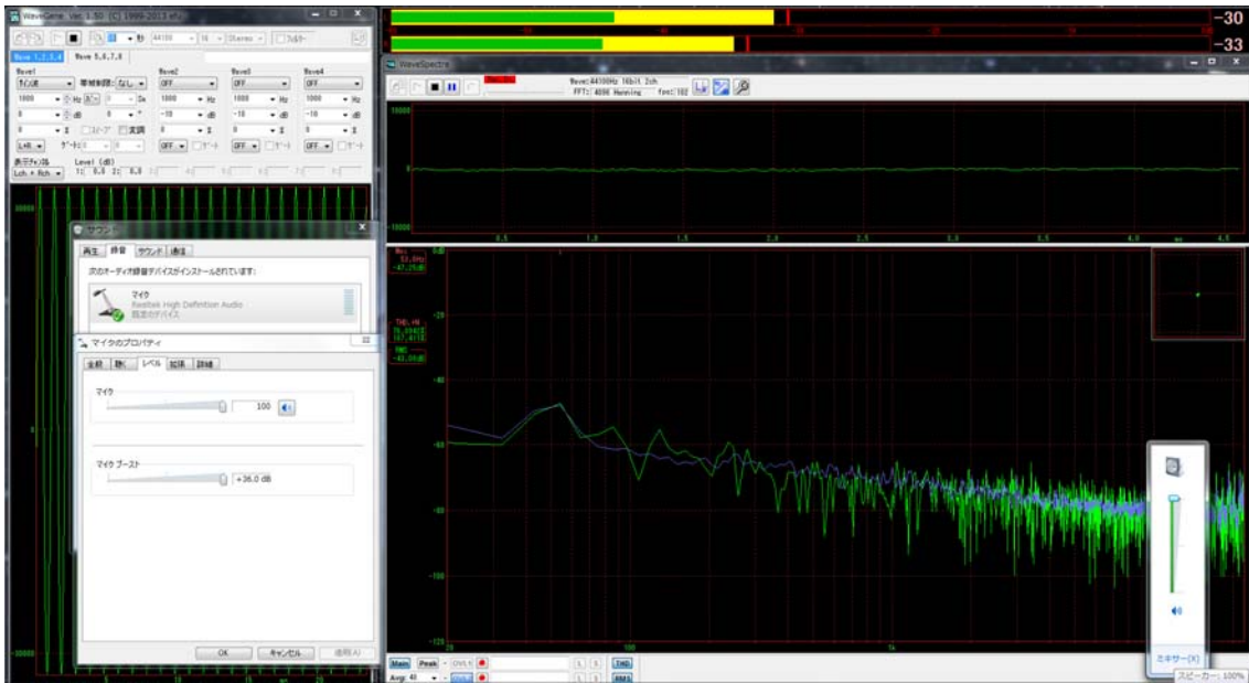
図 38 出力信号の入力信号への混入対策が十分な PC の例
