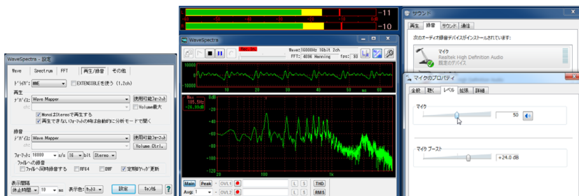
図 13 WaveGene の標本化周波数を 16kHz に変更して、録音状態でレベル調節する。
