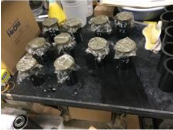
写真 3 モルタルのブリーディング試験の状況
