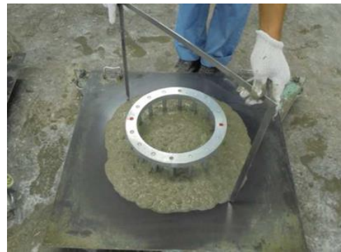
高流動コンクリートのJリングフロー試験の例
