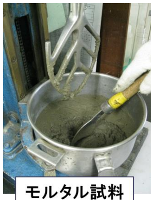
モルタル用けい砂の例とモルタルの練り混ぜ、供試体の作製例
