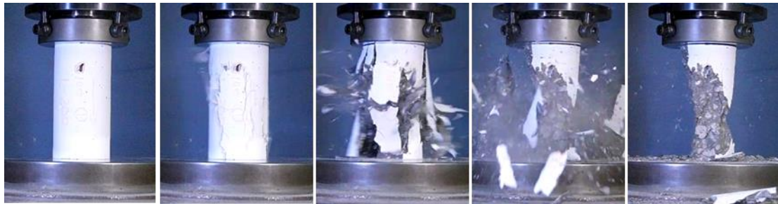
高強度コンクリートの圧縮強度試験（破壊状況）の例
