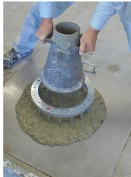
高流動コンクリートのJリングフロー試験の例
