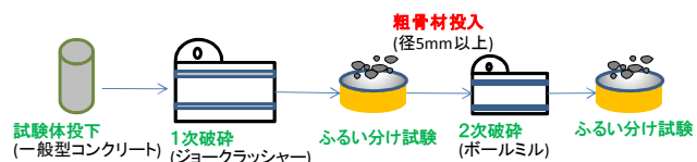
図 3 一般型コンクリートふるい分け試験方法
