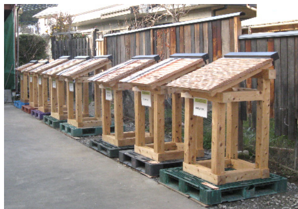
写真1 こけら台暴露試験状況
