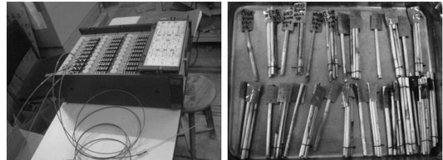
a) データロガーおよび熱電対      b) 燃焼実験に用いた試験体
