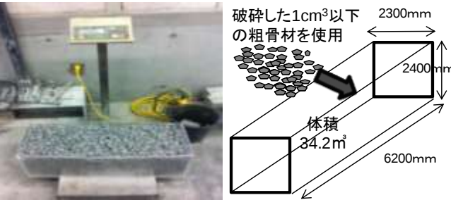
図 7 コンクリートがれきの荷台積載詳細図
