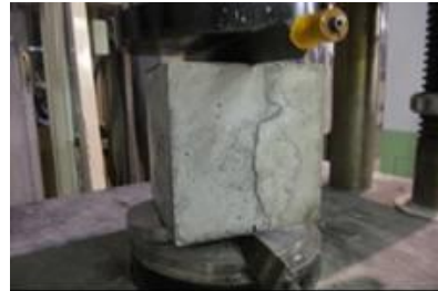
a) 割裂引張試験
