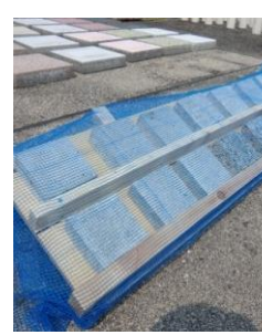
f) 屋外暴露の様子
