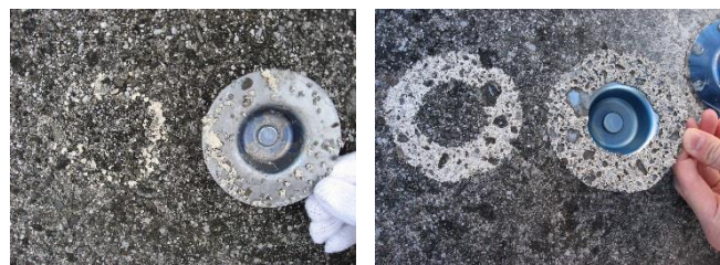
a) 接着剤充填率 20% (450N) b) 接着剤充填率 100% (2160N) 写真 3 接着剤充填率
