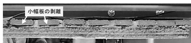
写真3 S10の最終加振後の各断面
