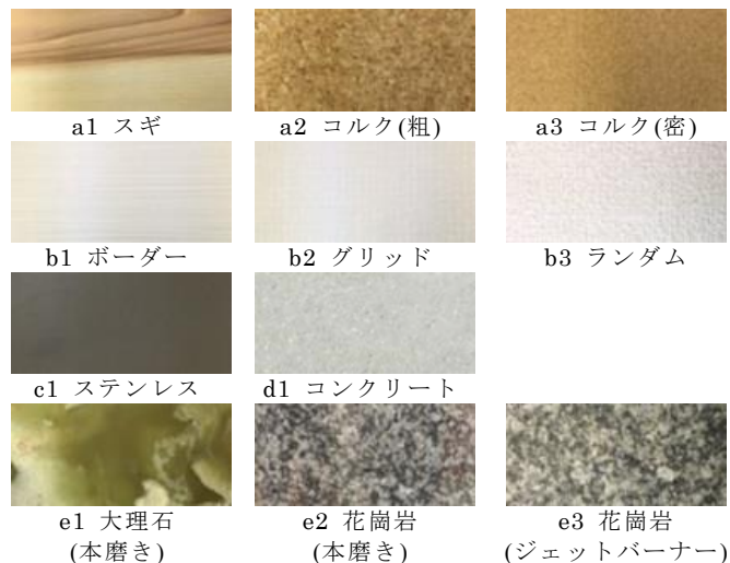
図5 実験に使用した意匠化粧材(B材)の事例
