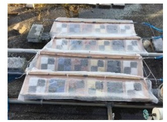
b) 苔付き建築仕上塗材試験体
