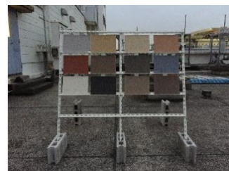
a) 建築仕上塗材試験体例
