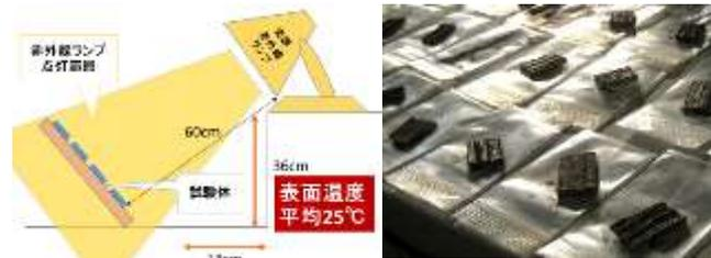
図 10 赤外線ランプ照射試験の様子
