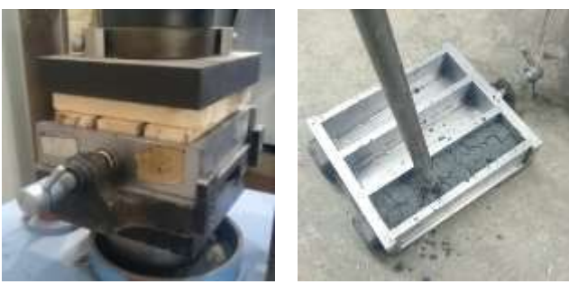
a) 圧縮の様子 b) 付き固めの様子
