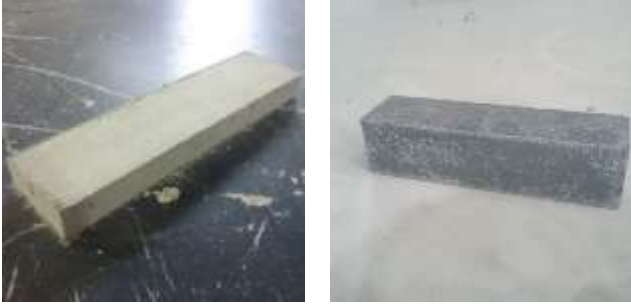
c) 圧力 10kN (水粉体比 40%) d) つき固め (水粉体比 60%)
