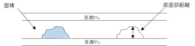
f) 模擬補修材の拡大面積・距離の平面図
