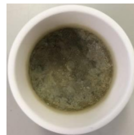
f) 廃材 F 標準（ \text{Na}_2\text{CO}_3 15%） 焼成後
