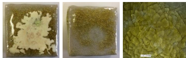
a) 廃材 F 標準 (1150℃、1 時間焼成、2mm 塗厚、 \text{Na}_2\text{CO}_3:50\% ) b) 廃材 W 木 (1150℃、1 時間焼成、2mm 塗厚、 \text{Na}_2\text{CO}_3:50\% ) c) b の 3D 画像解析
