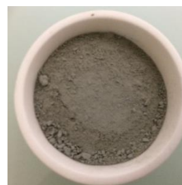
a) 廃材 F 標準（ \text{Na}_2\text{CO}_3 0%） 焼成前
