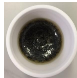
d) 廃材 W 木（ \text{Na}_2\text{CO}_3 0%） 焼成後
