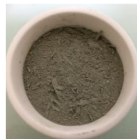
c) 廃材 W 木（ \text{Na}_2\text{CO}_3 0%） 焼成前
