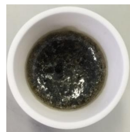
b) 廃材 F 標準（ \text{Na}_2\text{CO}_3 0%） 焼成後
