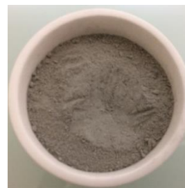
e) 廃材 F 標準（ \text{Na}_2\text{CO}_3 15%） 焼成前
