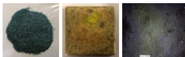
a) フェロニッケルスラグ b) 廃材 W 木 (1150℃、3 時間焼成、2mm 塗厚、 \text{Na}_2\text{CO}_3:50\% 、Ni10%) c) b の 3D 画像解析
