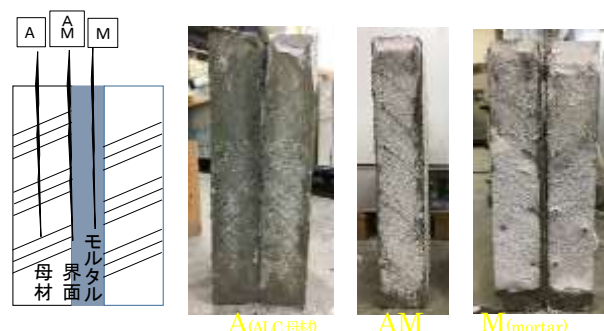
a) モード分類 b) モルタル破壊 c) 界面破壊 d) 母材破壊
