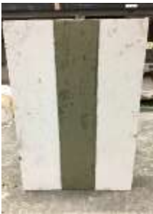
c) A タイプ壁面補強試験体
