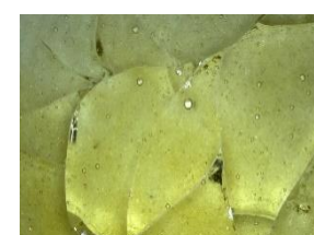
a) 図5・aの①温度で焼成 \text{NaHCO}_3 50% (30倍)
