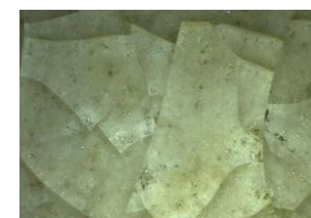
b) 図5(b)の④温度で焼成 \text{NaHCO}_3 50% (30倍)
