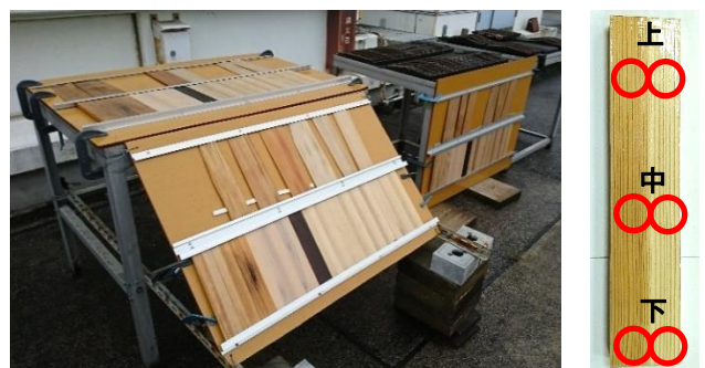
a) 曝露試験体 b) 測定箇所 図2 曝露試験体の様子と測定箇所
