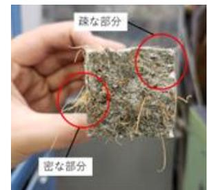
b) 試験体の割裂断面
