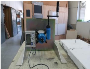
図 1 ビスパンチング試験方法
