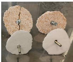
d)荷重によるビス引抜状況
