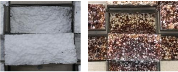
a)EPS の母材破断 b)EFR の母材破断
