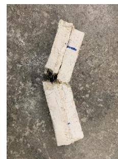
h) 試験体 A3 の界面での剥離
