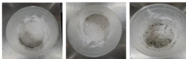
a) 石膏 b) a+ロックウール c) b+水(二水石膏) 写真2 吹付せっこうの調査・練り混ぜの様子
