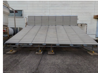
g) ECP屋外暴露試験体
