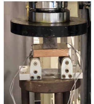
図6 衝撃荷重時の樹脂部圧縮変形特性(研究3)
