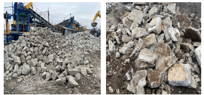
a) 土木由来の大径塊(再生骨材用) b) 建築由来の仕上付き塊(RC40 用)
