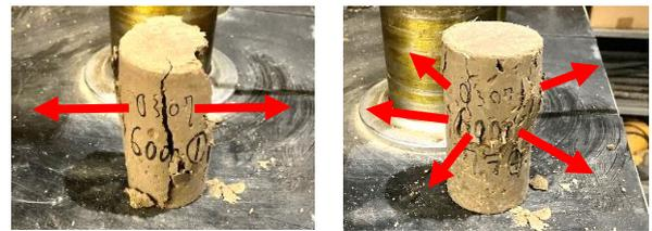
a) ワラスサなし (局所破壊) b) ワラスサ混成 (分散破壊)
