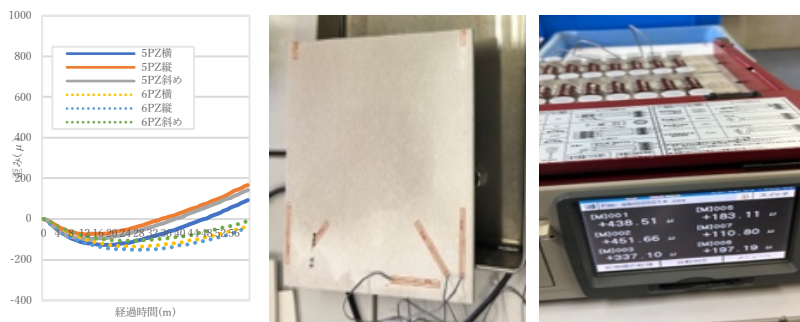
c) 漆喰パネル (基本板 PZ) の変形と貼り付け写真
