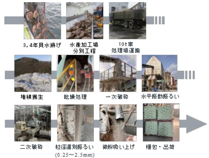
図5 ホタテ貝殻砂加工フロー
