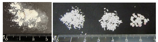
図6 粒径別ホタテ貝殻微粒分(左:微粒分、右:砂)
