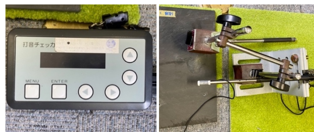
c) 打音チェッカーPDC-100 d) 一次共鳴振動数測定の様子
