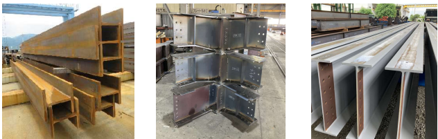
図 10 加工前の生材 (左) と鉄骨部材 (中・右) (B)
