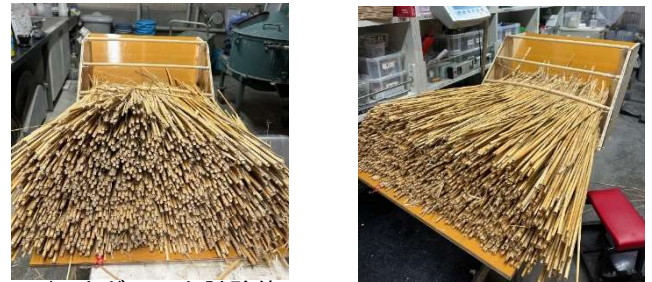
写真3 模擬屋根茅葺き試験体
