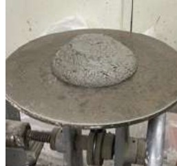
b) 15 打フロー試験の様子
