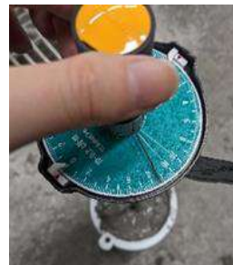
c) 最大せん断応力 (ND1, BD1) d) ベーンせん断試験の様子 図 7 実験 2 各モルタルのフレッシュ性状
