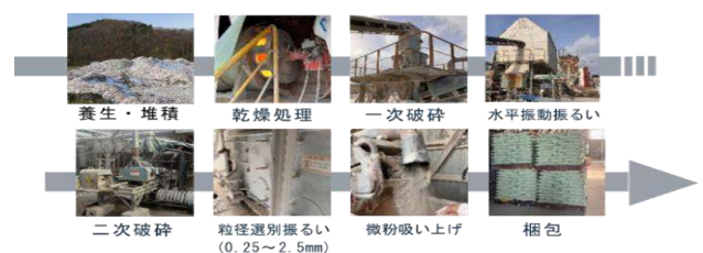
図 2 ホタテ貝殻砂加工フロー
