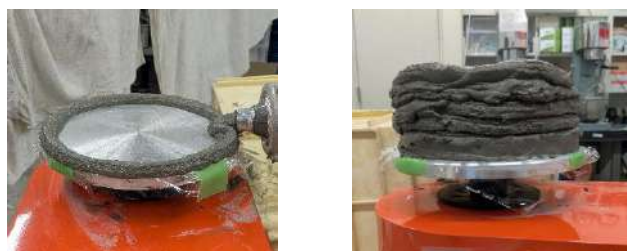
図 12 3DP 作成物(1 層目、7 層目積層後)
