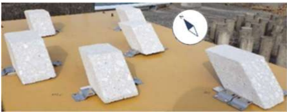
写真 1 屋外曝露試験体の設置状況
