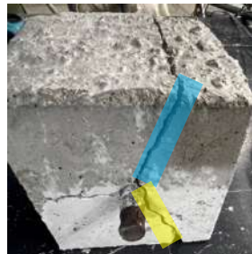
写真 8 青:躯体, 黄:仕上部破断
