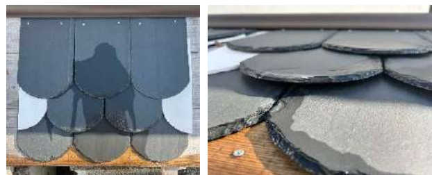
a) 流下後の全体の様子 b) 流下後の端部の様子 写真6 雨水流下試験の様子(研究5)
