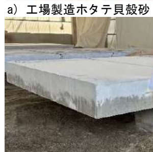
写真 1 現場施工 2 層打ち仕上げ PCa 部材パネル
