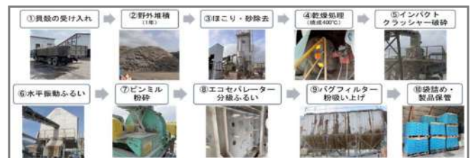
図 1 ホタテ貝殻砂の製造フロー
