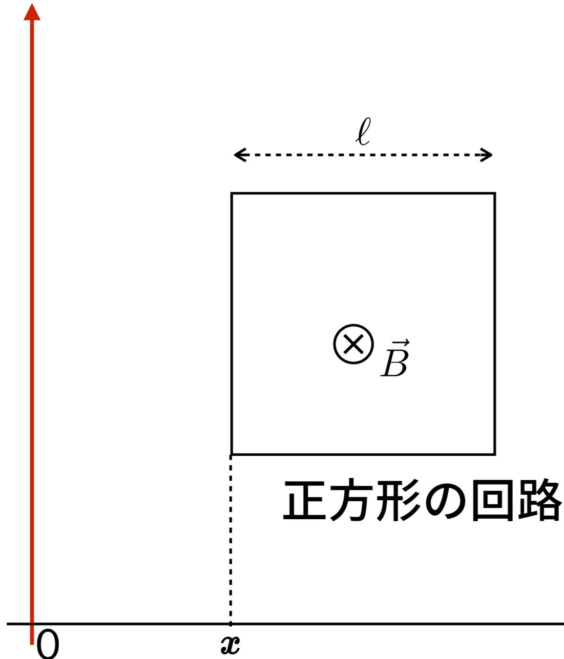
電流によって生じる磁束密度は図のような向き
