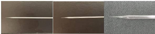
図 18 表 6 の(33)~(35)で示したパラメータで作製したピペットの写真。実験の 2.5 節で示した解析法で計測したテーパー長を各写真の上に示した。
