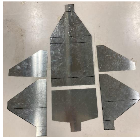
Fig6. 燃料タンク、オイルタンクの展開図 (左) 切り出し後のアルミ板 (右)
