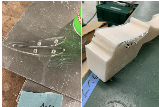
Fig20.(左図)アクリル翼型 (右図)フォーム翼型
