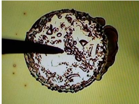
図 3-4 ±40 V の I-V 測定後の電極
